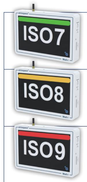
Lorsque la concentration en particules mesurée dépasse le seuil défini, **Wall-i ISO** alerte l'utilisateur en affichant la nouvelle classe particulaire et changeant la couleur du bandeau.
