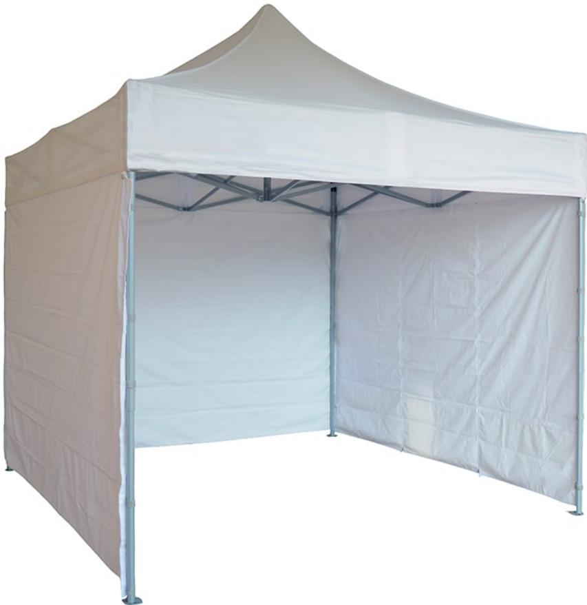
Tente pliante composée d'une structure parapluie en aluminium de section hexagonale 60 x 60 x 2 mm pour la partie supérieure et de 55 x 55 x 1.4 mm pour la partie inférieure. Les croisillons sont eux aussi fabriqué en aluminium, connecteurs et pièces de jonctions en plastique.
