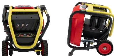
Le B230Li+ NEO 2 dispose d'une inclinaison réglable de -20° à +20° par pédale, d'un variateur de vitesse intégré mais aussi d'un indicateur de niveau de charge sur les batteries. L'appareil est commandé par bouton affleurant (clavier à membrane pour éviter les boutons exposés). Il est aussi conçu pour recevoir des gaines, adaptateurs mousses, brumisateurs et brumisateur de « rehab ».
