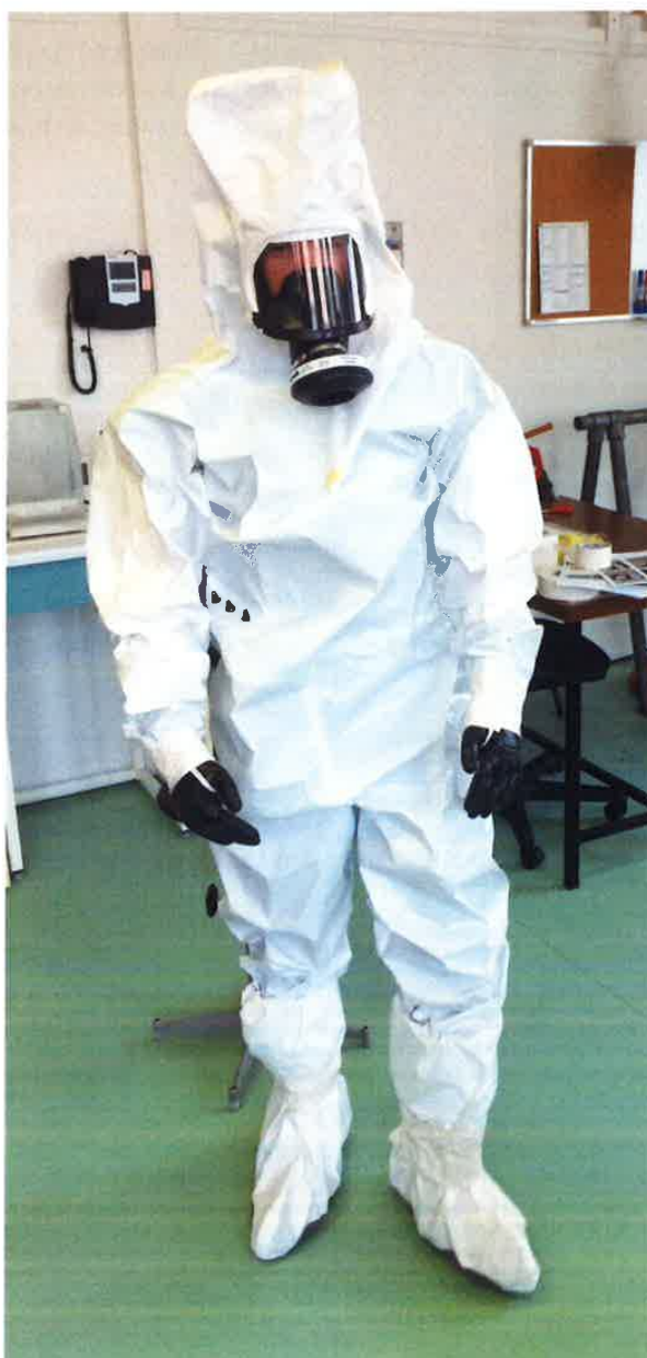
Figure 2 : photographie de l'équipement réf. Comat CGN fabriqué par la société Matisec revêtu par un des porteurs
