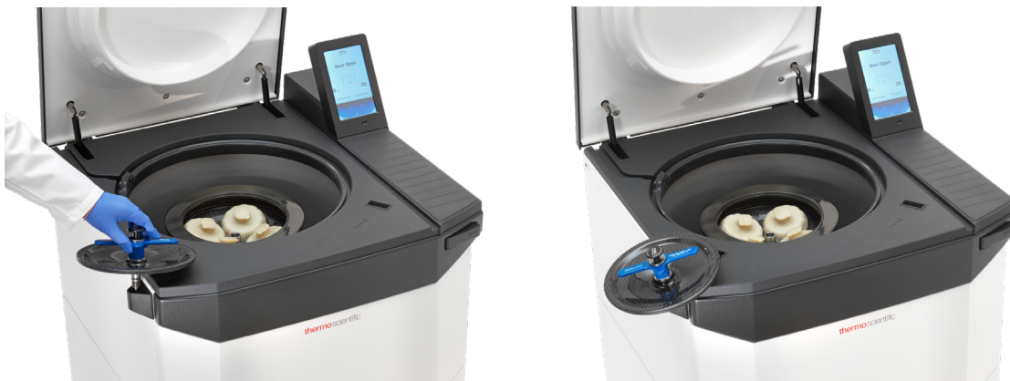
Figure 29: Utilisation du porte-couvercle du rotor Auto-Lock
