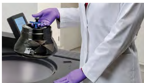
Rotors légers dotés de poignées Speed Handle
