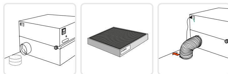
**Les caissons de filtration** sont équipés d'un filtre à charbon actif permettant de purifier les vapeurs toxiques dans l'enceinte du caisson et de les rejeter dans la pièce de manière saine. Les caissons de filtration doivent être équipés d'un filtre à charbon actif qu'il y a lieu de changer au moins une fois tous les ans.
