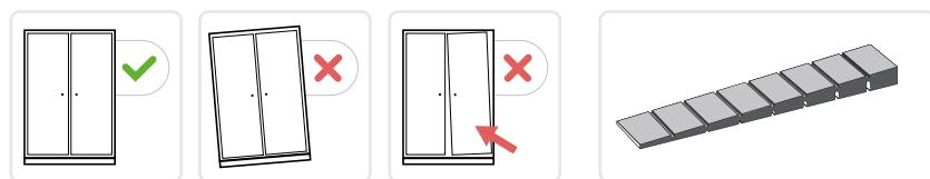
L'armoire doit être installée sur une surface parfaitement plane et pouvant supporter le poids de celle-ci en pleine charge.
