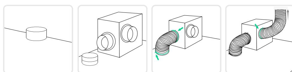
Les caissons de ventilation sont reliés à l'armoire à l'aide d'un kit de raccordement (comprenant un manchon de raccordement, deux colliers de serrage et un mètre de gaine flexible) sur la sortie de ventilation située en toiture. Le ventilateur inclus dans le caisson permet de ventiler l'intérieur de l'armoire en aspirant l'air chaud pour éviter l'accumulation de chaleur et de le rejeter à l'extérieur de l'établissement à l'aide d'une extraction en toiture ou au mur.
