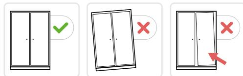
L'armoire doit être installée sur une surface parfaitement plane et pouvant supporter le poids de celle-ci en pleine charge.
