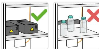
Cette armoire est exclusivement destinée au stockage et à la recharge de batteries au lithium-ion dans les zones de travail. Elle ne doit en aucun cas servir au stockage de produits chimiques (acides, bases, magnésium, autres métaux (sous forme poudreuse)). La recharge d'une batterie lithium-ions génère de la chaleur !
