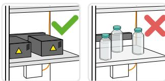
Cette armoire est exclusivement destinée au stockage et / ou à la recharge de batteries au lithium-ion dans les zones de travail. Elle ne doit en aucun cas servir au stockage de produits chimiques (acides, bases, magnésium, autres métaux (sous forme poudreuse)). La recharge d'une batterie lithium-ions génère de la chaleur !
