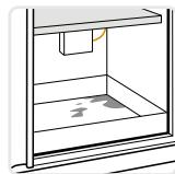
L'armoire est équipée d'un bac de rétention permettant de contenir les fuites d'électrolyte des batteries endommagées et fuyantes
