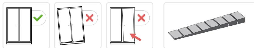
L'armoire doit être installée sur une surface parfaitement plane et pouvant supporter le poids de celle-ci en pleine charge. Veillez à ce que l'ensemble de l'armoire soit correctement calé afin que l'armoire ne puisse pas basculer et que le système de fermeture automatique des portes fonctionne correctement (ce système est vérifié avant l'expédition). Les éventuelles mises à niveau et le calage sont à effectuer par l'utilisateur.
