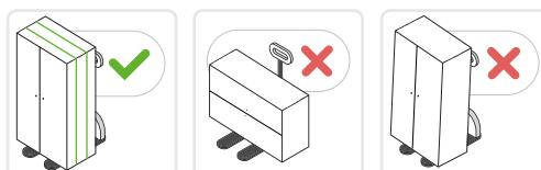
L'armoire de sécurité que vous venez de recevoir a été protégée et transportée dans des conditions optimales afin qu'elle soit préservée de toute altération due au transport. L'armoire de sécurité doit être soulevée uniquement par le bas à l'aide d'un moyen approprié (ventouse, sangle...).
