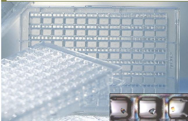
Plaques en polystyrène à 96 puits pour la cristallographie des protéines. Conçues pour les utilisations robotisées en HTS, pour l'étude de protéines recombinantes sous diverses conditions paramétrables pH, température, pression de vapeur.
