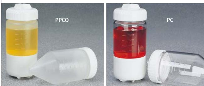
➤ En copolymère de polypropylène ou en polycarbonate avec bouchon en polypropylène (joint silicone)
