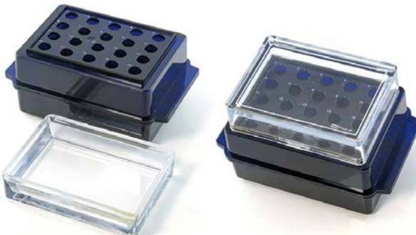
Portoirs réversibles réfrigérants de paillasse pour 20 microtubes 1,5 ml sur une face ou 0,5 ml sur l'autre face. En polycarbonate incassable, remplis d'un gel non toxique, ils sont munis d'un couvercle transparent.
