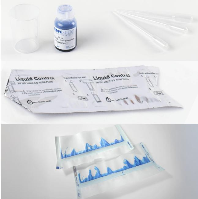
■ Test avec une solution bleutée mettant en évidence les canaux et les défauts des soudures de manière rapide et fiable.
