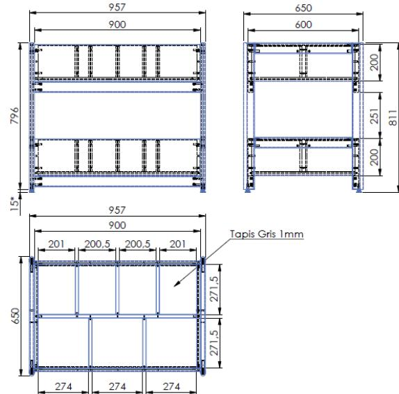
Dimensions : Longueur 957mm hauteur 810mm profondeur 650mm
