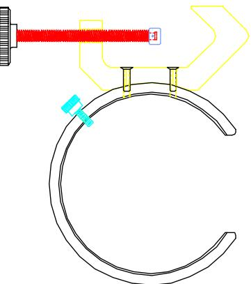
Le support de réservoir est utilisé pour monter un réservoir sur le support IV.
