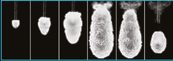
Dynamique de bulle de Vapor Tunnel™
