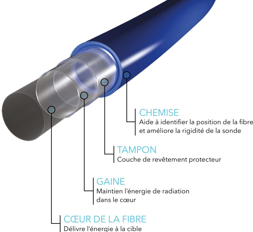
Les fibres optiques pour laser Quanta System sont conçues pour transmettre efficacement l'énergie et garantir une sécurité maximale pendant la chirurgie laser.
