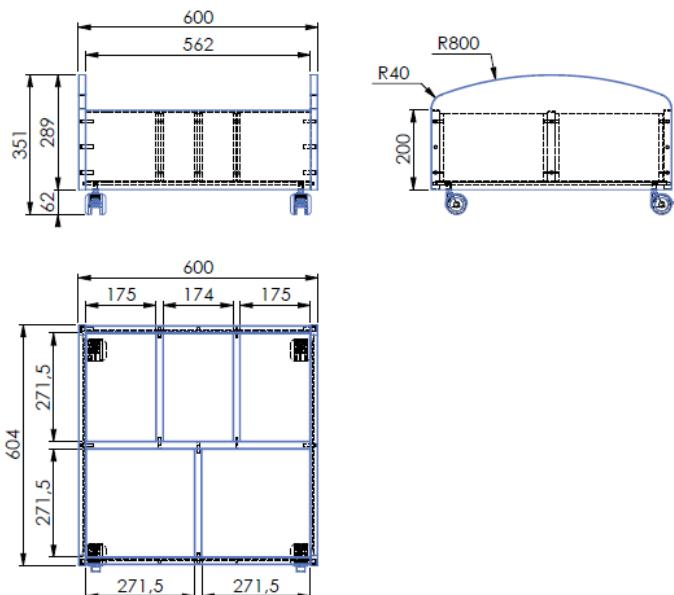
Dimensions : Longueur 604mm hauteur 351mm profondeur 600mm
