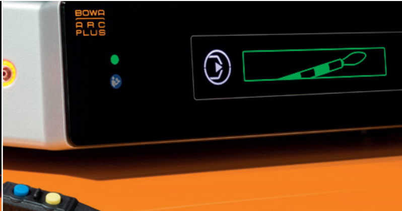
L'affichage vert indique la purge (argon) des instruments connectés
