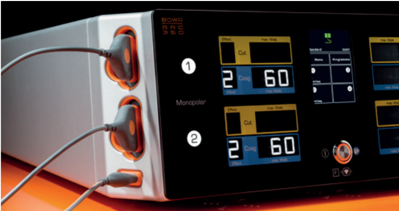
Efficace : En cas de coagulation monopolaire, les deux manches peuvent être activés simultanément
