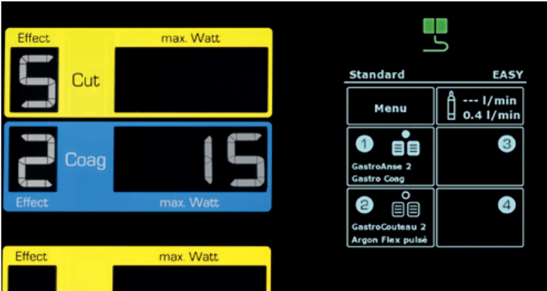
Hautement flexible : GastroCut permet 6 types de coupes à l'anse ou aux électrodes de couteau (jusqu'à 9 effets)
