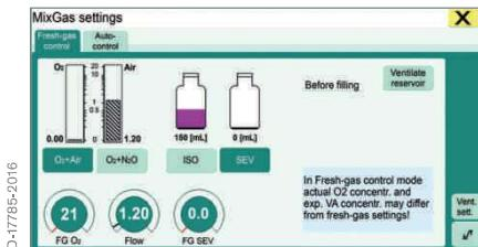
Les paramètres de gaz frais avec gaz vecteur « AIR » permettent de régler à 21 % la concentration en O<sub>2</sub> afin d'administrer de l'air pur. La fonction ORC (régulateur du taux d'oxygène) sensible garantit que le système reçoit au moins 250 mL/min d'oxygène.
