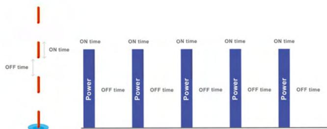
Composé d'un train de pulses rapides (microsecondes) dont la durée et les intervalles sont personnalisables, ce mode d'émission permet la modulation de l'effet thermique dans les tissus cibles.
